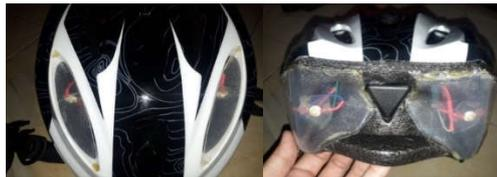
Gambar 3. Penempatan Posisi Lampu Sein Bagian Depan dan Belakang
