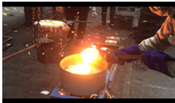
Gambar 3. Proses pengecoran sentrifugal
