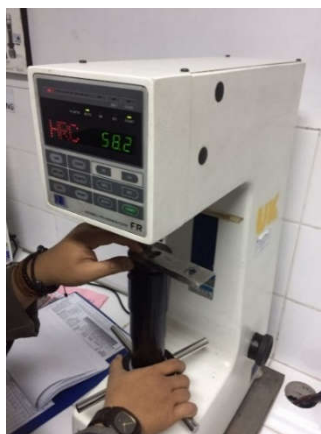
Gambar 7. Proses pengujian kekerasan Rockwell
