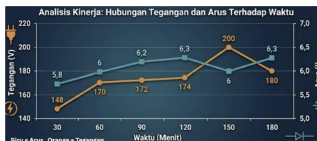
Gambar 12. Grafik kinerja Genset Biogas yang Terkoneksi Mesin Pengupas Kulit Kacang Tanah
