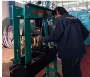
Gambar 4. Pencetakan Briket Batu Bara
