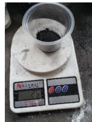
Gambar 3. Pencampuran Antrasit dan Tepung Tapioka
