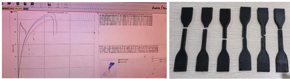
Gambar 3. Hasil Uji Tarik Spesimen Material EPA PLA CF Standar ASTM D638 Tipe IV
