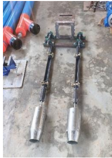
Gambar 9. Proses Perakitan Rangka dan Sistem Transmisi Waterjet Propulsion (Sumber: Dokumentasi Pribadi)
