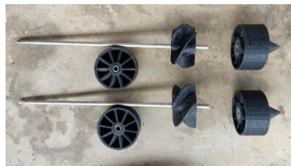
Gambar 8. Hasil Cetak Komponen Utama Waterjet Propulsion material EPA Polylactic Acid Carbon Fibre (EPA PLA CF) siap rakit (Sumber: Dokumentasi Pribadi)
