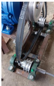
Gambar 10. Proses Alignment Sistem penggerak Waterjet Propulsion (Sumber: Dokumentasi Pribadi).
