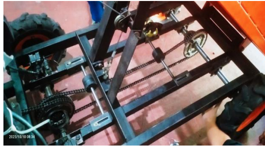
Gambar 9. Sistem Penggerak Penuh Waktu (4x4) dan Sistem Naik Turun Bak Penampung.
