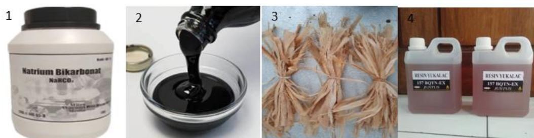
Gambar 2. Bahan Pembuatan Komposit: 1. \text{NaHCO}_3 , 2. molase, 3. serat waru, dan 4. resin polyester
