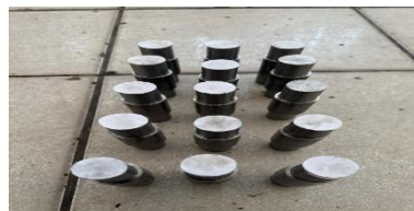
Gambar 6. Benda Kerja Setelah Dibubut Menggunakan Mesin Bubut CNC
