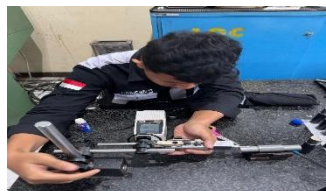
Gambar 7. Pengujian Kekasaran Permukaan Pada Benda Kerja
