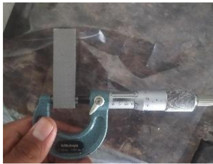
Gambar 5. Mengambil Data Kerataan Menggunakan Mikrometer 0,001 mm
