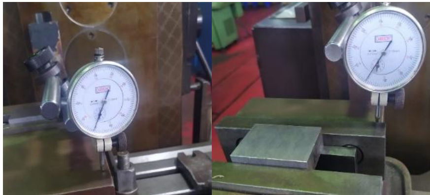
Gambar 2. Pengukuran Arah Sumbu Y dan X
