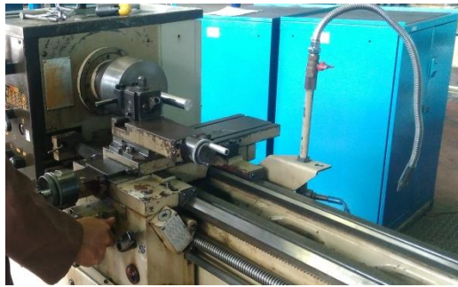
Gambar 4 Proses pemotongan benda uji pada mesin bubut Doall LT 13 di lab mekanik Politeknik manufaktur negeri bangka belitung
