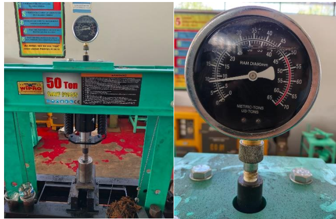
Gambar 1. Proses pencetakan dan tekanan yang diberikan pada cetakan
