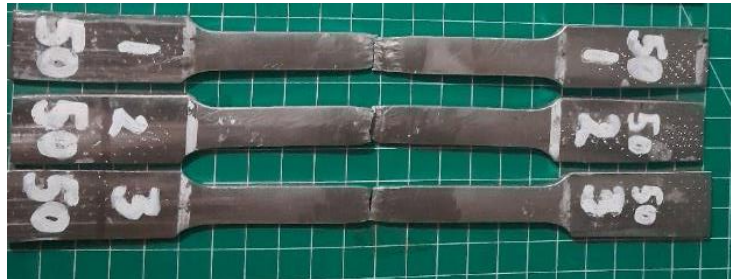
Gambar 9. Posisi Patahan Dari 3 Spesimen Uji
