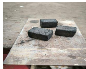
Gambar 5. Briket Setelah Pengeringan dibawah Sinar Matahari
