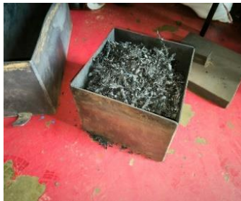
Gambar 1. Serbuk Gergaji Kayu Setelah Karbonasi
