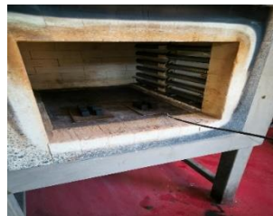
Gambar 6. Proses Pengeringan Briket Menggunakan Furnance
