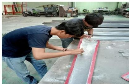
Gambar 7. Proses Pencetakan Bilah Turbin
