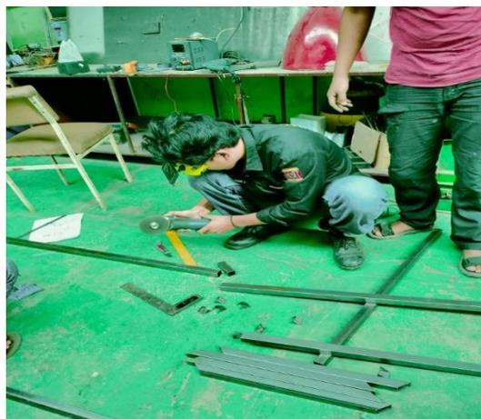
Gambar 11. Pemotongan Plat Besi
