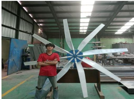
Gambar 19. Tampak Depan Uji Coba Pemasangan Bilah dan Generator
