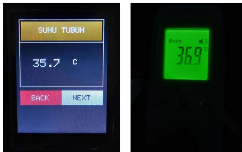
Gambar 9. Pengujian Pengukuran Suhu Tubuh
