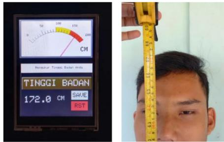
Gambar 8. Pengujian Pengukuran Tinggi Badan
