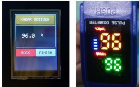
Gambar 10. Pengujian Pengukuran Kadar Oksigen Dalam Darah
