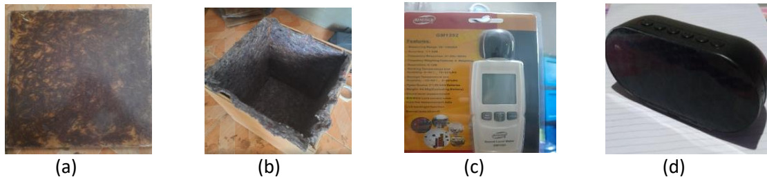
Gambar 2. Alat – alat Yang Digunakan Dalam Pengujian (a) Spesimen Komposit, (b) Kotak Uji, (c) Sound Level Meter , (d) Speaker
