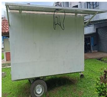
Gambar 8. Tampak Samping Box Kontainer Stasiun Pengisian Gas Hidrogen (*Refuelling Hydrogen Gas Station*)
