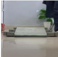
Gambar 6. Warping Pada Hasil Cetak 3D
