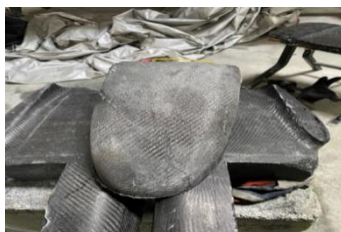
Gambar 4. Hasil Material Komposit Dengan Metode Vacuum Bagging
