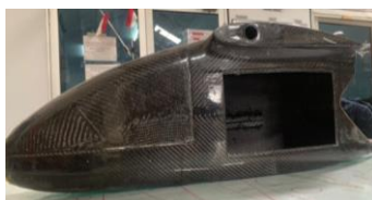
Gambar 5. Hasil Assembly Part Part Yang Sudah Dicitak Dengan Metode Vacuum Bagging
