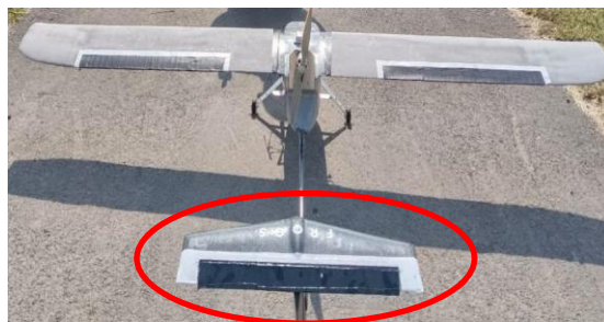
Gambar 21. Aerofoil Pada Horizontal Stabilizer
