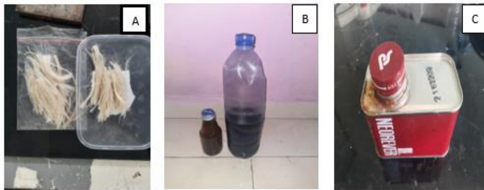
Gambar 3. a. Serat Lidah Mertua, b. Resin Poliester dan Katalis, c. NaOH
