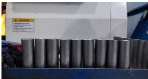
Gambar 1. Bentuk Material Baja ST 40
