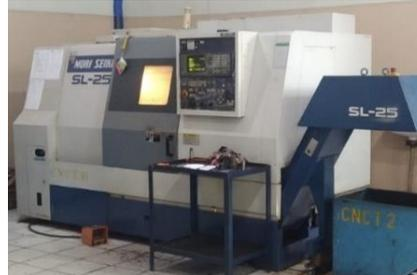
Gambar 2. Mesin bubut CNC MORI SEIKI SL-25
