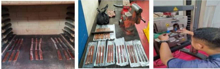
Gambar 5. Sampel Uji Tarik dan Pengujian Tarik
