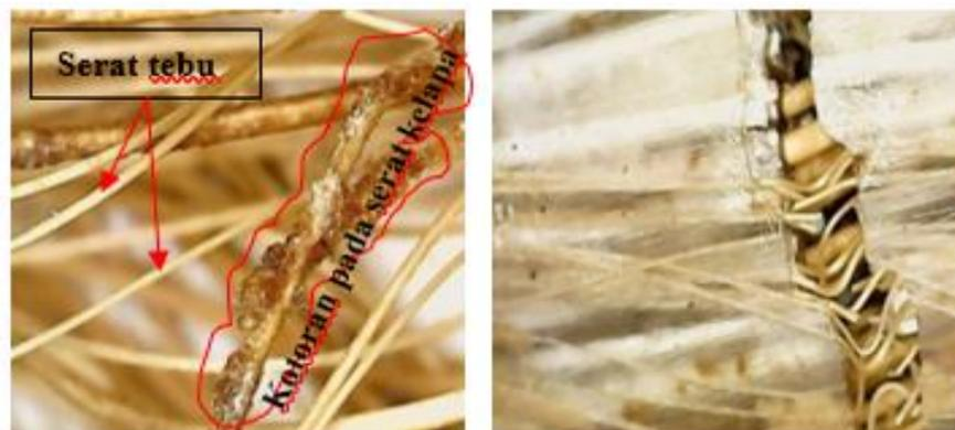
Gambar 6. Foto Mikro Patahan Hasil Pengujian Tarik
