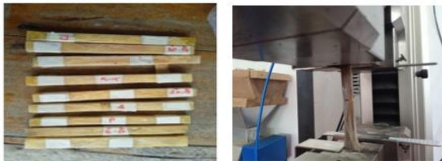
Gambar 4. Bentuk Sample Uji Tarik Dan Proses Pengujian Tarik
