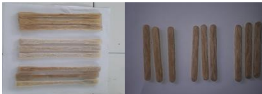
Gambar 6. Sampel Uji Tarik dan Uji Impak
