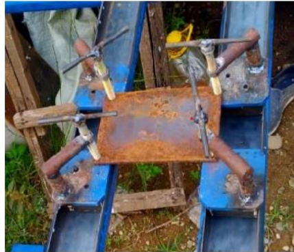
Gambar 4. Pengujian Klem Pada Benda Kerja [7].
