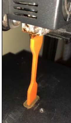
Gambar 4. Proses Pencetakan Spesimen ujian
