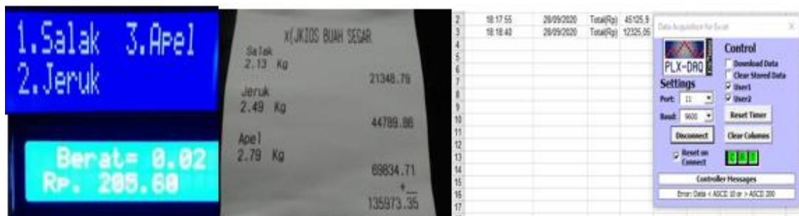
Gambar 5. Hasil pengujian Timbangan digital dengan printer thermal database pada excel
