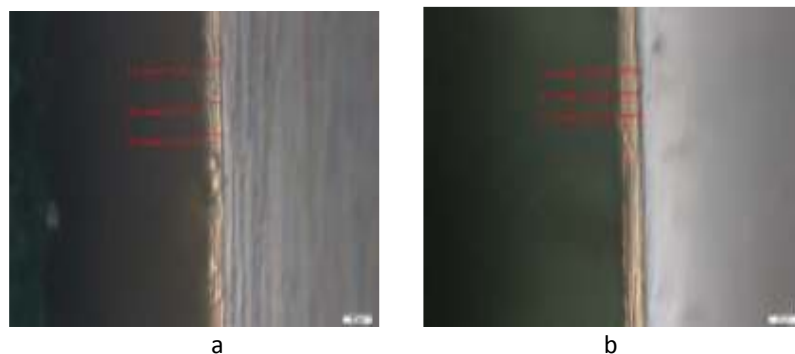
Gambar 7. Pelapisan Pada Temperatur 40°C dengan Variasi Waktu, a). 10 menit, dan b). 15 menit
