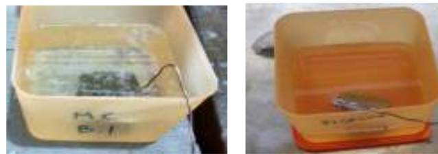
Gambar 4. a). Metal Cleaner (NaOH), b). Larutan Pickling (HCl)
