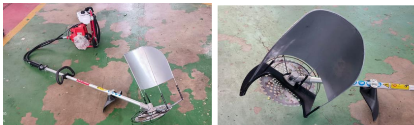
Gambar 7. Mesin Pemotong Padi Dengan Mesin Rumput 2 Tak
