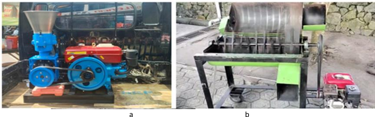
Gambar 1. Mesin Produksi yang diberikan kepada Mitra a).Mesin Pencetak Pelet b). Mesin Pencacah Bahan Pembuatan Pelet
