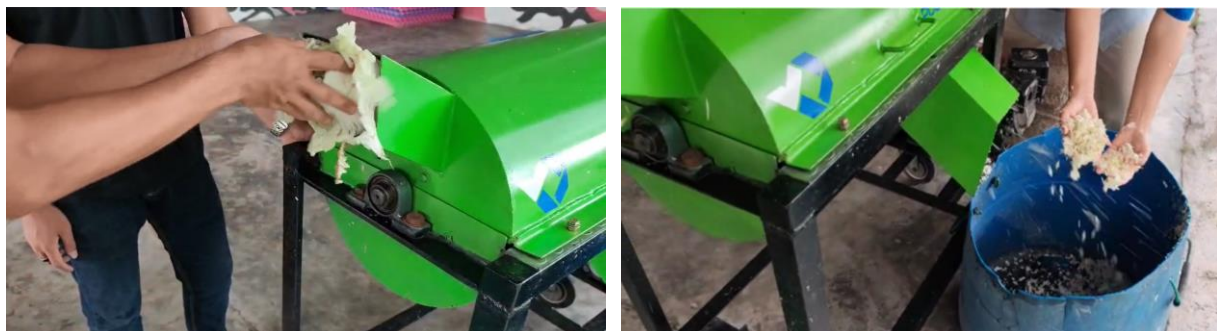
Gambar 4. Pengoperasian Mesin Pencacah Bahan Pembuatan Pelet
