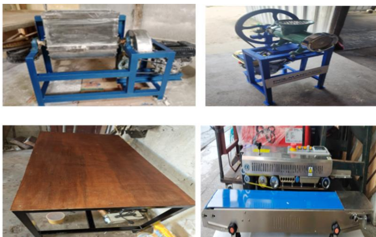
Gambar 9. Mesin Pengaduk Adonan, Mesin Pengiling Ikan Dan Meja Mesin Pengemas
