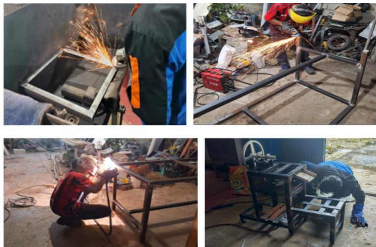
Gambar 8. Proses Pembuatan Mesin Pengaduk Adonan, Mesin Pengiling Ikan Dan Meja Mesin Pengemas
