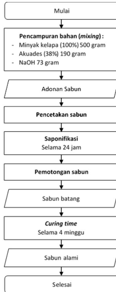
Gambar 2. Tahapan Pembuatan Sabun Alami
