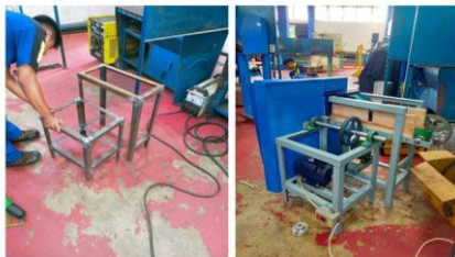
Gambar 1. Proses Pengerjaan Mesin Perajang Daun Talas Beneng
