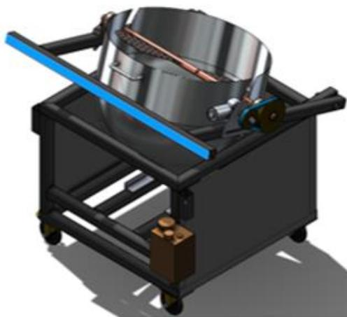
Gambar 5. Rancangan Alat Yang Digunakan Untuk Pengorengan Stik Ikan
