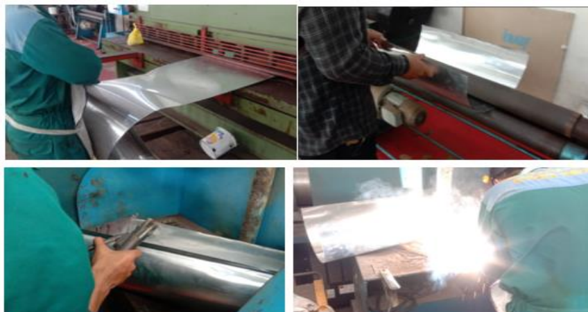
Gambar 5. Proses Pengerolan Pelat Untuk Pembuatan Mesin Pengaduk
