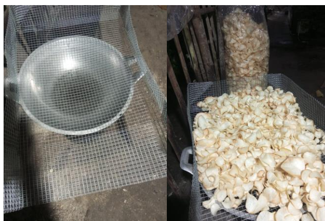
Gambar 1. Proses Pengeringan/Ditiris Keripik Singkong Yang Sudah Digoreng Secara Manual
