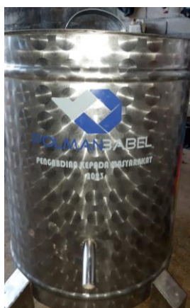
Gambar 2. Mesin Pengering Minyak Keripik Singkong Kapasitas 10 kg
