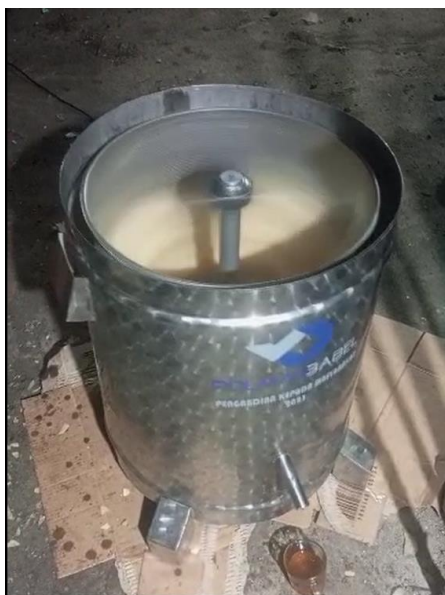
Gambar 3. Proses Pengeringan Minyak Keripik Singkong
