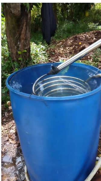
Gambar 8. Penempatan Pipa Uap Di Dalam Drum Plastic
