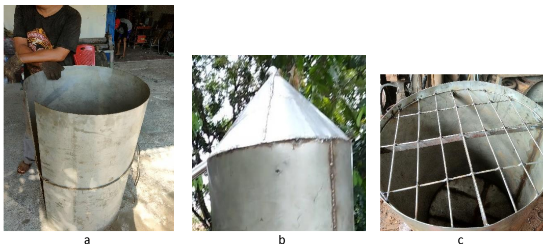
Gambar 6. Pembuatan Tabung Bahan Baku. (a) Proses Bending, (b) Penutup Bagian Atas Berbentuk Kerucut (c) Penutup Bagian Bawah Dengan Besi Rajutan Bersekat
