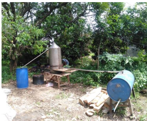
Gambar 9. Instalasi Penyulingan Yang Sudah Dirakit
