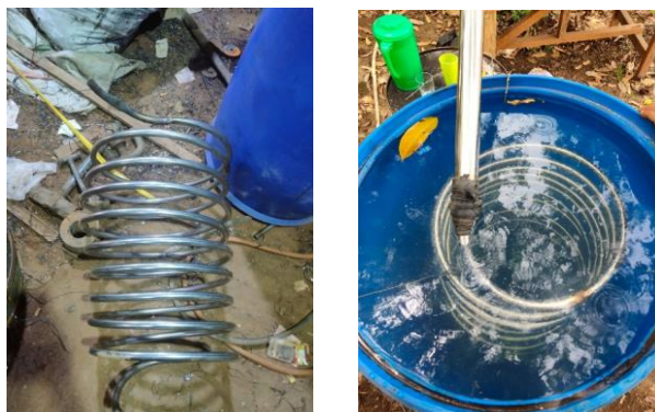
Gambar 7. Pipa Saluran Uap (Pipa Spiral)
