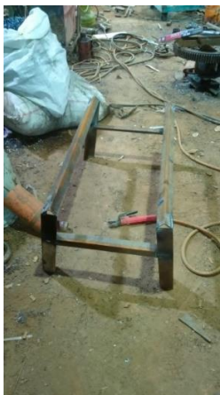
Gambar 4. Proses Pembuatan Rangka/Dudukan Tungku Ketel
