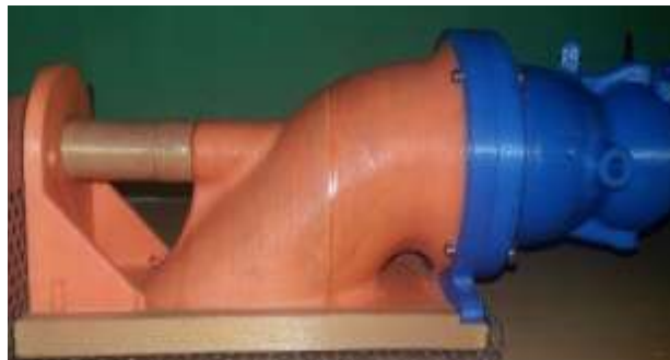
Gambar 3. Turbojet Drive Produk 3D Printing (Sumber: Pribadi)
