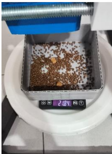
Gambar 7. Ujicoba Keluaran Pakan dalam 1 Siklus Putaran Motor Feeder
