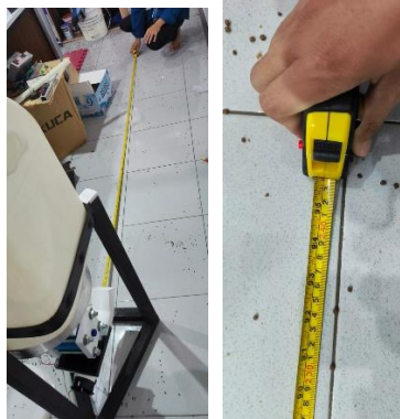
Gambar 6. Pengukuran Jarak Lontaran Pakan Jarak Minimum = 240 cm dan maksimum 530cm
