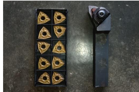
Gambar 3. Insert WNMG080404-TSF T9225G Dan Holder
