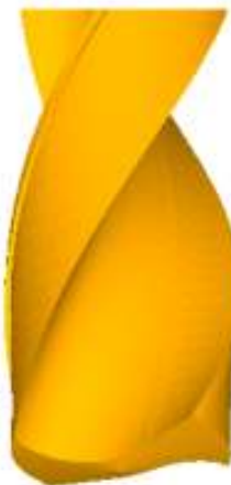
Gambar 2. Pemodelan Drill Bit atau Pahat Potong yang Digunakan pada Penelitian
